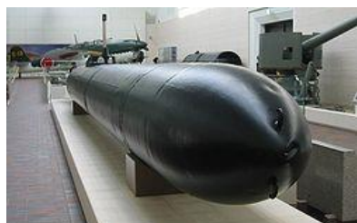
遊就館に展示されている回天1型 ハッチの開閉は手動で内部から開けられた。 全長約15m、直径約1m(一人乗り) (ウィキペディアより転載)
